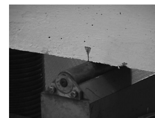
Estado limite de formação de fissuras
