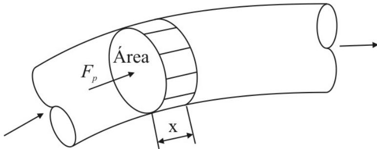
Para que o fluido “entre” no volume de controle, uma força, proveniente da pressão ( $F_p$ ) deve impeli-lo. O trabalho desta força é  $W_p = F_p x$  ou  $W_p = p A x$ . Deste modo, a potência desta força é  $\dot{W}_p = p A x / \Delta t$ , ou ainda  $\dot{W}_p = p A V$ . Caso a pressão e a velocidade não sejam constantes na área o trabalho é calculado assim:
