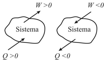
**Q – calor:** é definido como a energia em transito devido à diferença de temperaturas e que não esta associada com transferência de massa.
