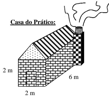
Os coeficientes de transferência de calor por convecção nos lados interno e externo da casa são iguais a 5 W/m<sup>2</sup>.K e 15 W/m<sup>2</sup>.K, respectivamente.
