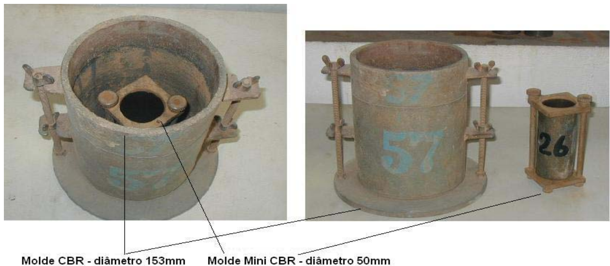
Figura 2.1- Diferença de dimensões dos cilindros de CBR e Mini CBR;
